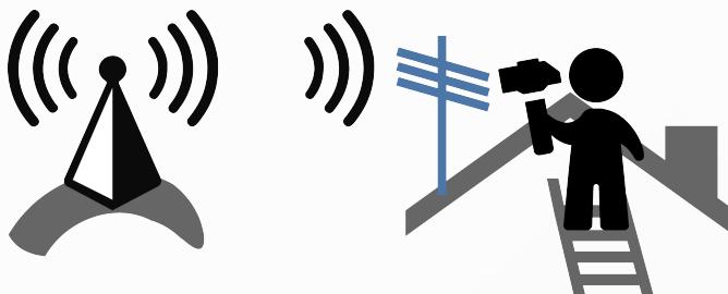
Антенна должна быть направлена на вышку сотовой связи и расположена строго вертикально. Разъем для подключения кабеля должен располагаться с нижней части антенны.
